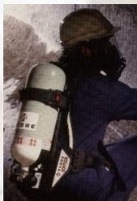
Appareil de protection respiratoire autonome avec masque complet.
