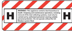
Identification de la classe H de l'aspirateur sur le capot (norme EN 60335-2-69)
